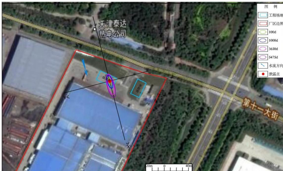
图 5.2-5 非正常状况下不同时间点醋酸乙酯污染羽（15mg/L）示意图
