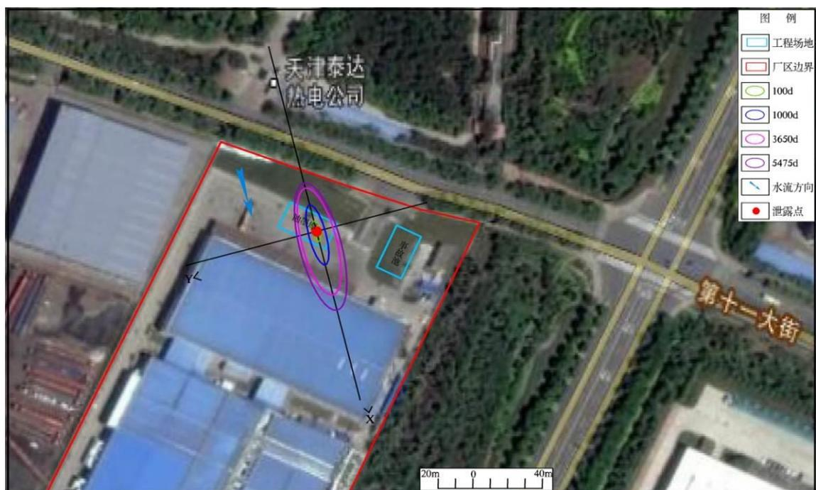
图 5.2-4 非正常状况下不同时间点石油类污染羽（0.01mg/L）示意图
