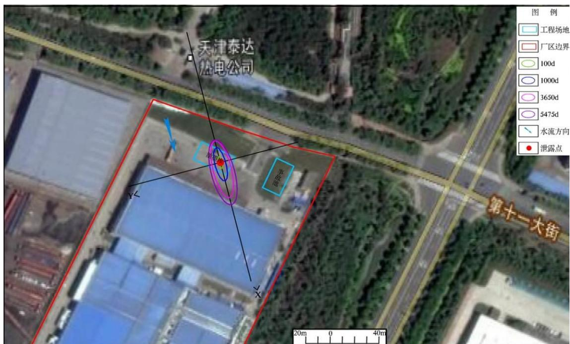
图 5.2-3 非正常状况下不同时间点石油类污染羽（0.3mg/L）示意图
